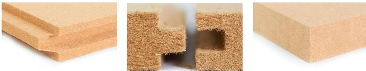
Выпускаются теплоизоляционные плиты плотностью от 50 кг/м<sup>3</sup> до 200 кг/м<sup>3</sup>. Всего в линейке 10 наименований продукции. Каждый вид имеет различный вид кромки - прямая, шип-паз, ступень. Максимальная ширина и длина составляет 2,85 м, толщина варьируется от 20 до 240 мм.
